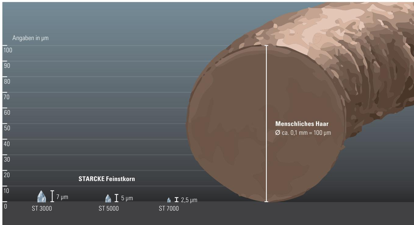
Im Vergleich zum Durchmesser eines menschlichen Haares wird deutlich: STARCKE Feinkorn bedeutet Spitzentechnologie im µ-Bereich. Für einen optimalen Schliff mit konstanten Rautiefen.
