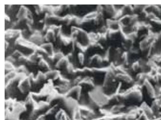
Unser besonderes Know-how bei der Herstellung von Feinstkorn-Schleifmitteln findet seinen Ausdruck im STARCKE-eigenen Feinstkorn-Standard mit der Kornkennzeichnung „ST“. STARCKE Feinstkörnungen gibt es aktuell in den Korngrößen ST 1.500\*, ST 2.000\*, ST 2.500\*, ST 3.000\*, ST 5.000\* und ST 7.000\*.
