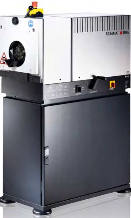
RASAMAT s centrálním prizmovým vedením
