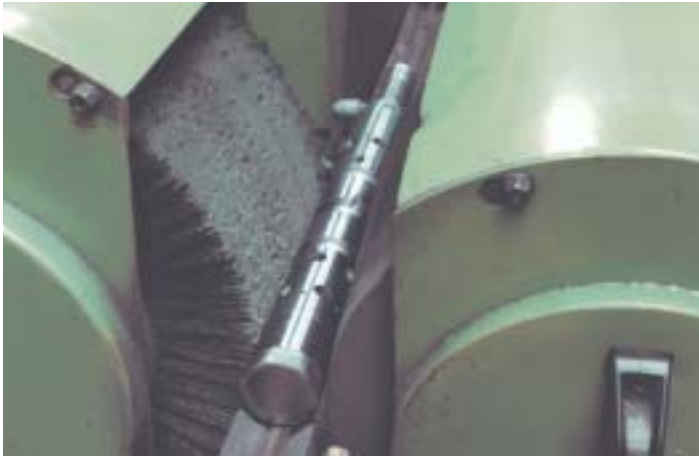
Entgraten von Hydrauliksteuerkolben. Deburring of hydraulic control pistons.
