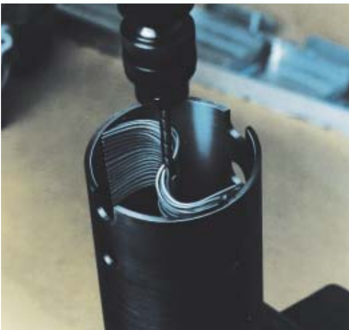
Verbesserung der Oberfläche eines Pneumatikzylinders. Improvement of finishing on pneumatic cylinder.
