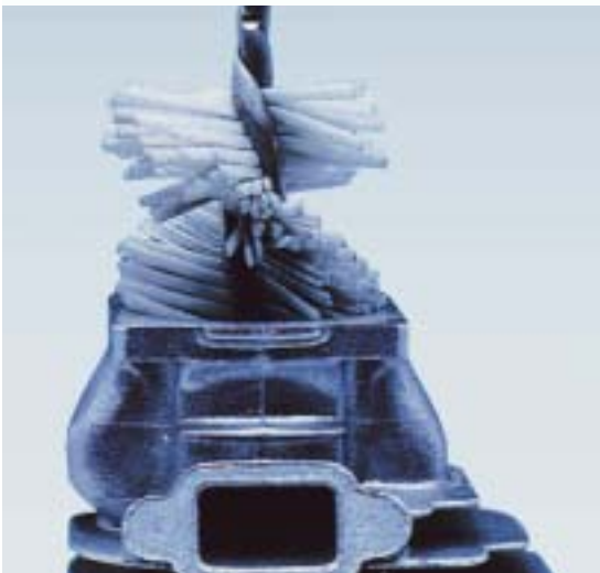
Entgraten eines Zylinderkopfes (Zweitaktmotor). Deburring of cylinderhead (two-stroke engine).
