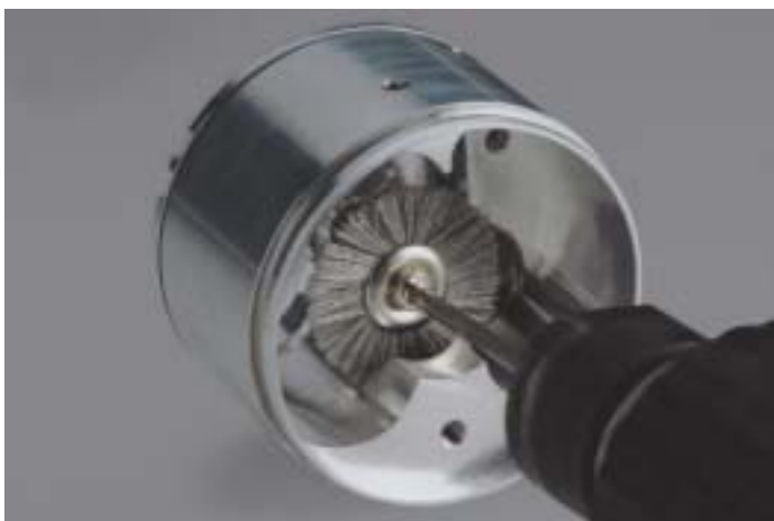
Aluminiumgehäuse, Entgraten Aluminium housing, Deburring
