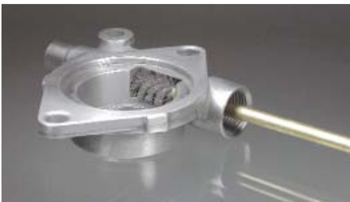
Ventilgehäuse, Entgraten von Querbohrung Valve housing, Deburring the cross holes
