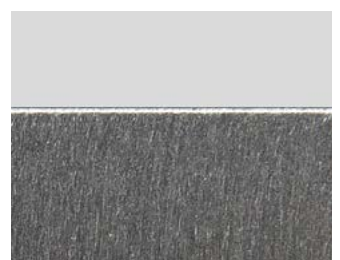
Nach der Bearbeitung - Grate wurden zuverlässig entfernt und die Kanten verrundet. Die Oberfläche hat eine ebenmäßige, gebürstete Optik.
