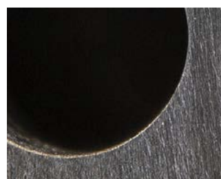
Nach der Bearbeitung - Grate wurden zuverlässig entfernt und die Kanten verrundet. Die Oberfläche hat eine ebenmäßige, gebürstete Optik.
